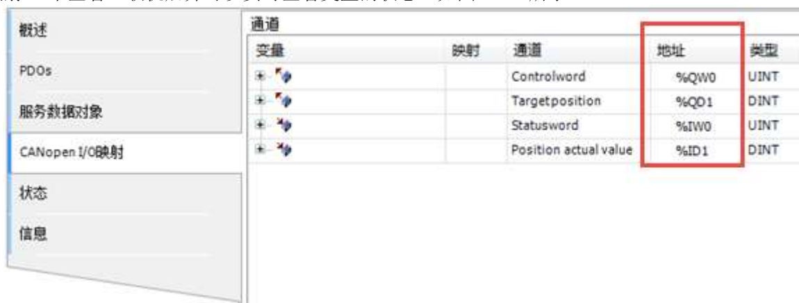
图 12.32 CANopen I/O 映射状态图
