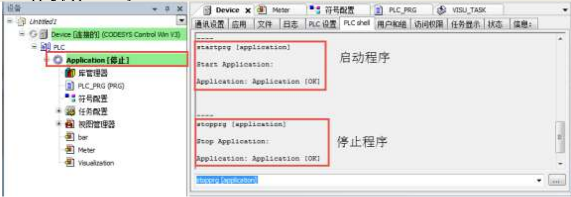
图 6.46 脚本命令执行启动/停止程序
