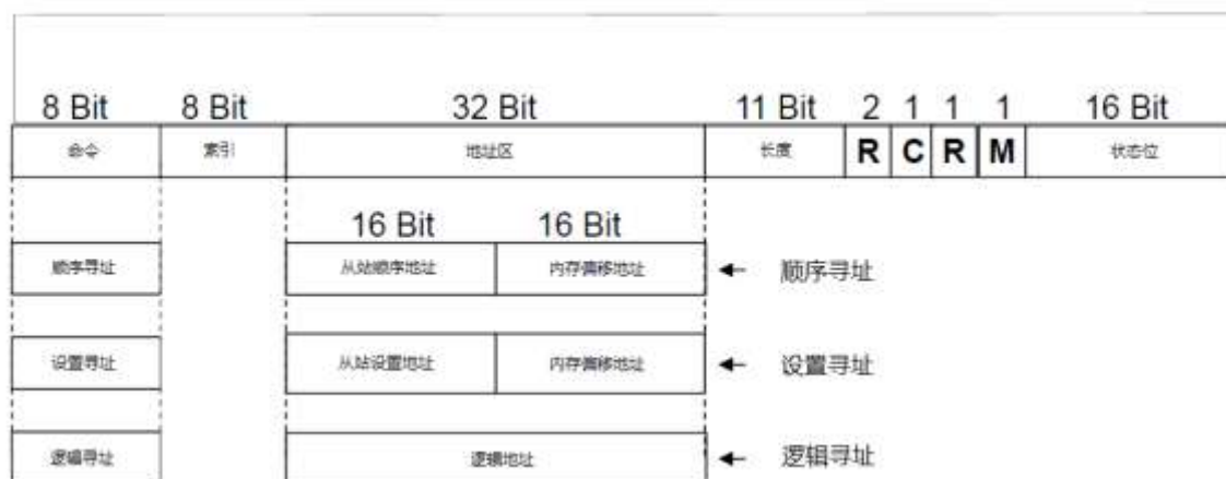
图 12.100 EtherCAT 的设备寻址结构
