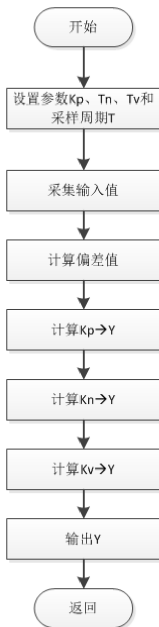
图 9.18 标准 PID 控制器控制流程
