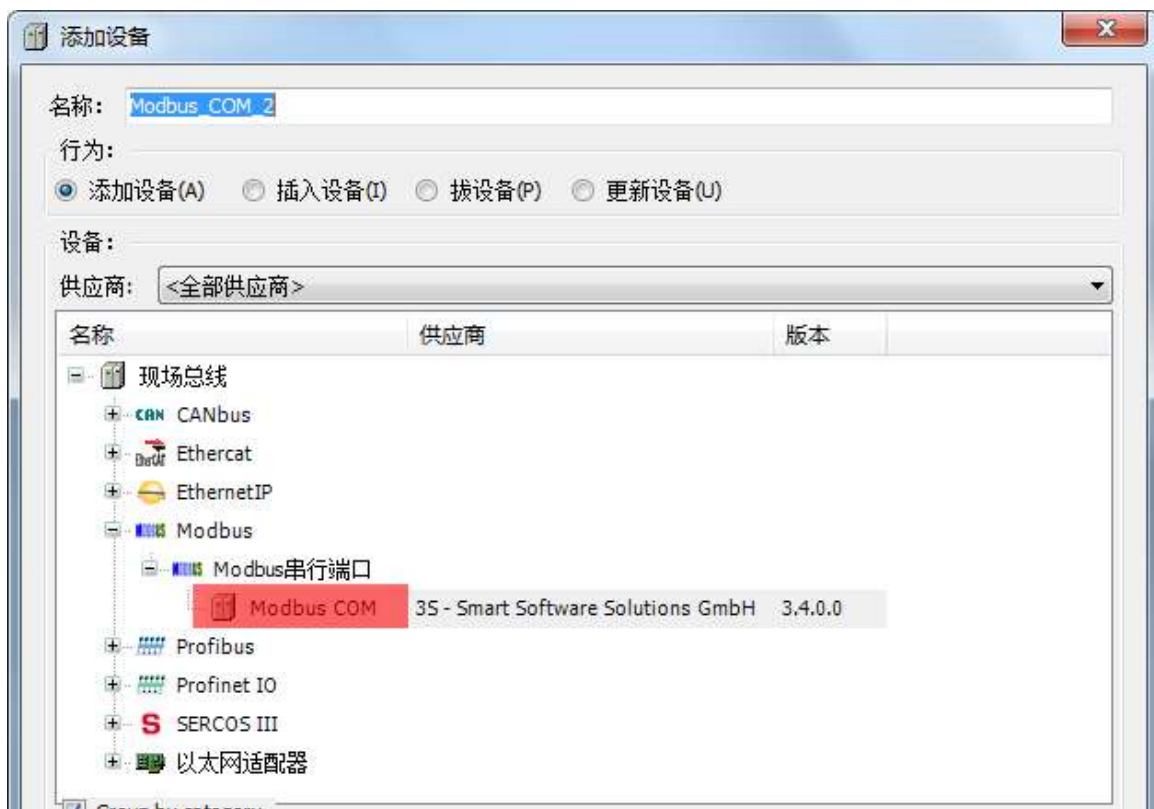
图 12.77 Modbus 串行通信及接口
